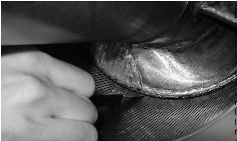
Fig. 13-17: Medición de la ranura de trabajo entre criba y sinfín realizada en el lado inferior de la criba con la máquina parada; se mide la doble ranura de trabajo dado que en estado parado la criba se apoya en el lado superior del sinfín.
