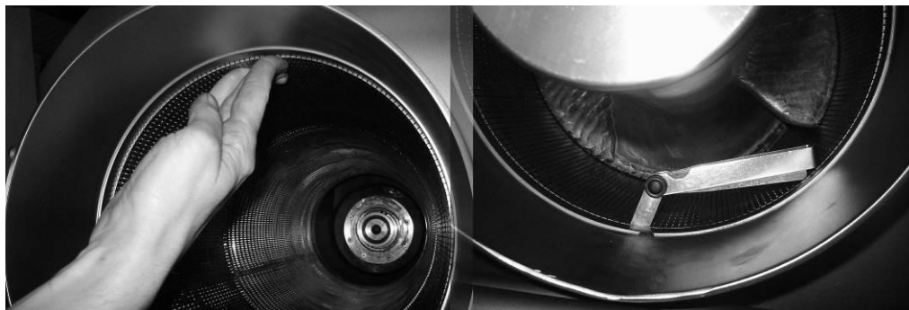
Fig. 13-13: Criba móvil en el separador, comprobación de la capacidad de flotar con la mano (a la izquierda)
