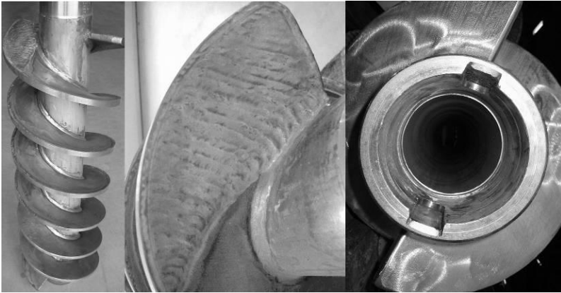
Fig. 13-14: Sinfín reforzado de material especial y alojamiento de cubo, estado nuevo
